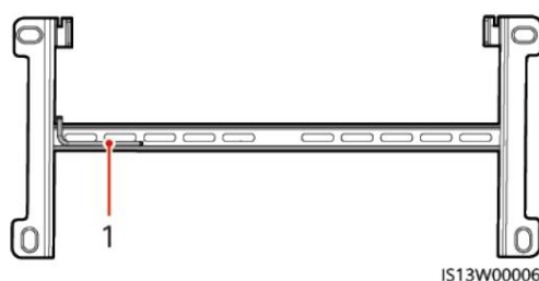
Figura 4-9 Poziția pentru fixarea cheii Torx de securitate
